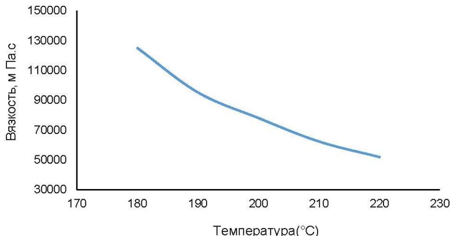
**Указания по применению:** Рабочая температура на ролике - 190 - 220°C
