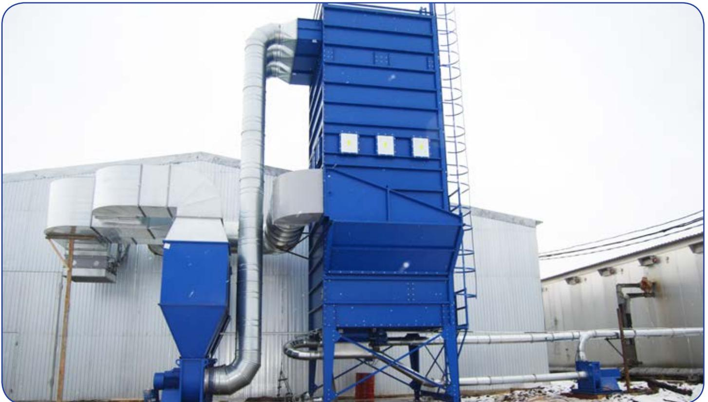
Система асрации 50 000 м<sup>3</sup>/час. Рукавный фильтр с вибровстряхиванием ФР-50СБ.
