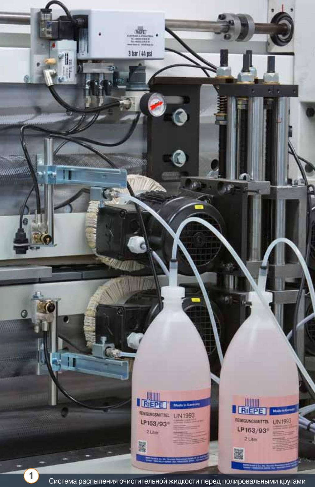
**1** Система распыления очистительной жидкости перед полировальными кругами
