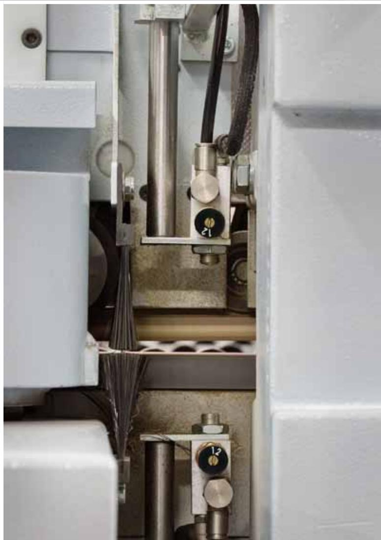
**2** Система распыления разделительной жидкости внутри кожуха
