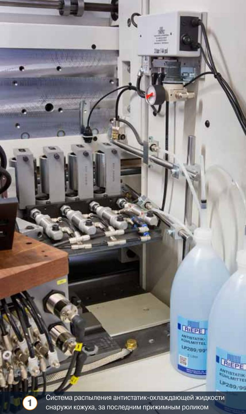
**1** Система распыления антистатик-охлаждающей жидкости снаружи кожуха, за последним прижимным роликом
