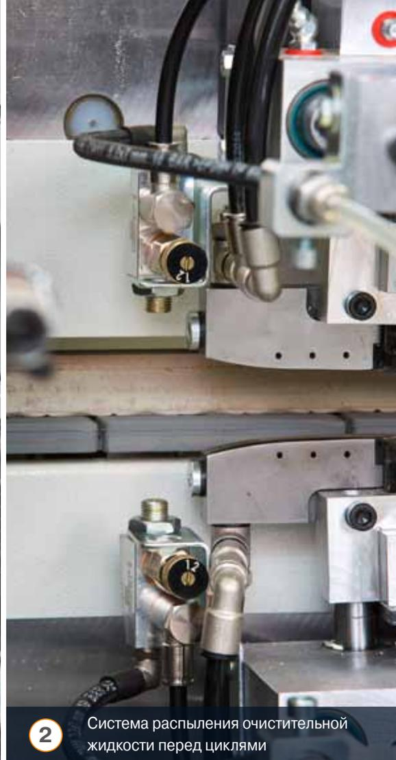
**2** Система распыления очистительной жидкости перед циклями
