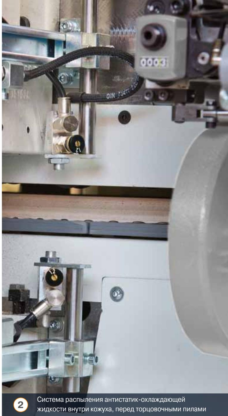
**2** Система распыления антистатик-охлаждающей жидкости внутри кожуха, перед торцовочными пилами
