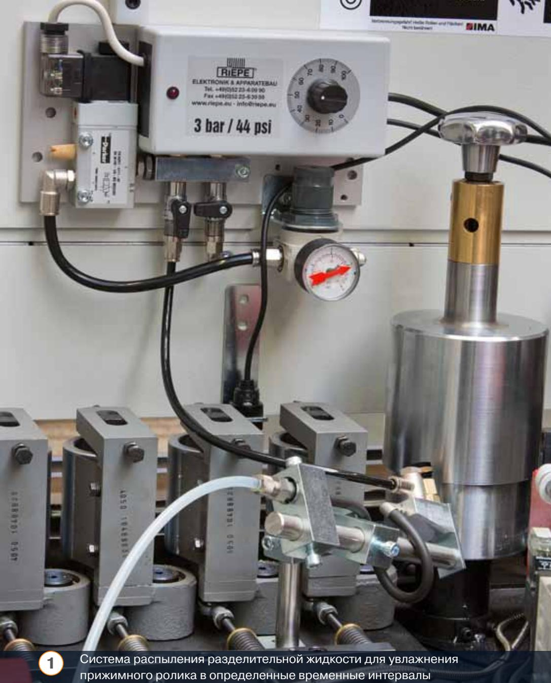
**1** Система распыления разделительной жидкости для увлажнения прижимного ролика в определенные временные интервалы
