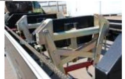
**UH500H** – станок для раскря брёвен угловым способом с использованием механизма автоматического поворота пильного блока и с гидравлической станиной.
