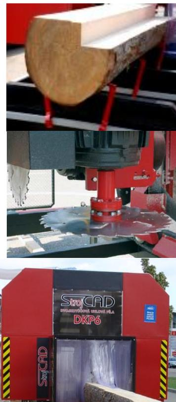
**DKP-6** – станок с расположением пил под углом 90 градусов относительно друг друга. Это позволяет получить **2 доски за один цикл** реза (рез происходит при движении пильной головы вперёд и назад) и значительно снизить расходы на распиловку за счёт экономии электроэнергии и расходных материалов.
