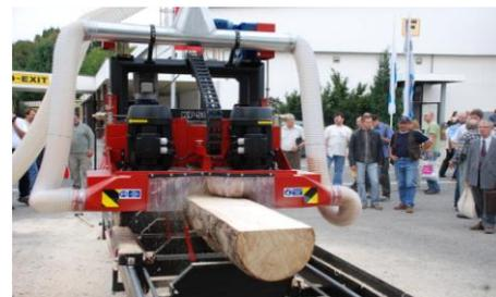
**КР-58Н**-станок предназначен для распиловки бревен на необрезную, обрезную доску, лафет, брус с гидравлической станиной. Производительность достигает 50 куб. м. бревен за 8-ми часовую смену.
