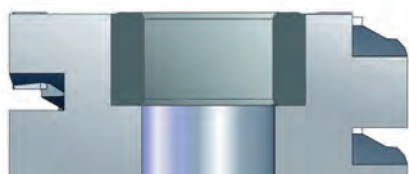
BOCCOLA IN ACCIAIO SPECIALE CORPO IN ALLUMINIO
