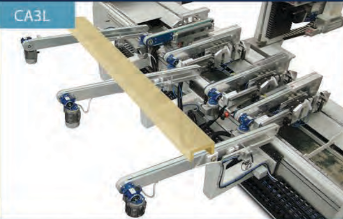
CA3L automatic frontal loader with horizontal magazine with motorized belts and lateral pieces' discharger CA3L автоматический фронтальный загрузчик, горизонтальный накопитель с моторизованными ремнями и выгрузкой деталей с боковой стороны станка CA3L automatyczny podajnik przedni z poziomym magazynkiem z napędzanymi taśmami i bocznym wyładunkiem elementów CA3L 型自动前端进料装置带装配电动皮带的水平储料架与侧边工件卸料装置
