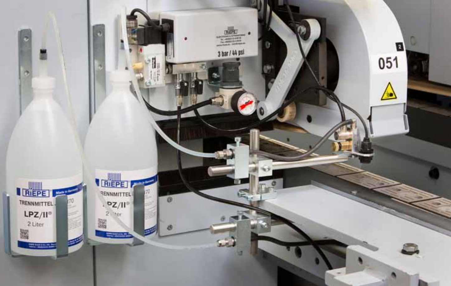
Система распыления разделительной жидкости снаружи кожуха, на направляющей
