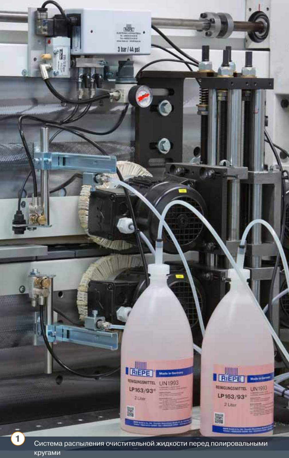
2 Система распыления очистительной жидкости перед циклами
