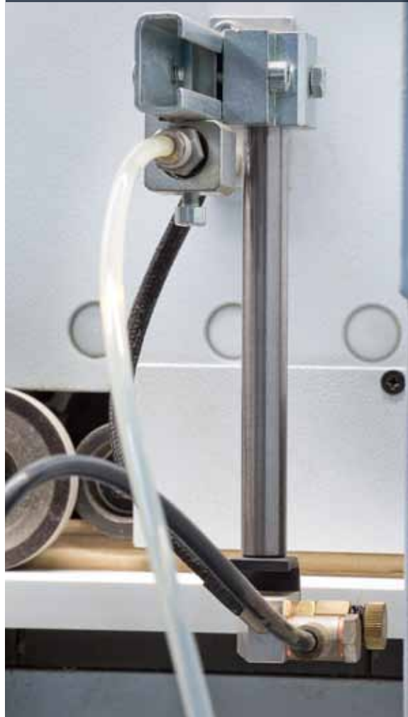
2 Отдельное решение для бокового увлажнения кромки
