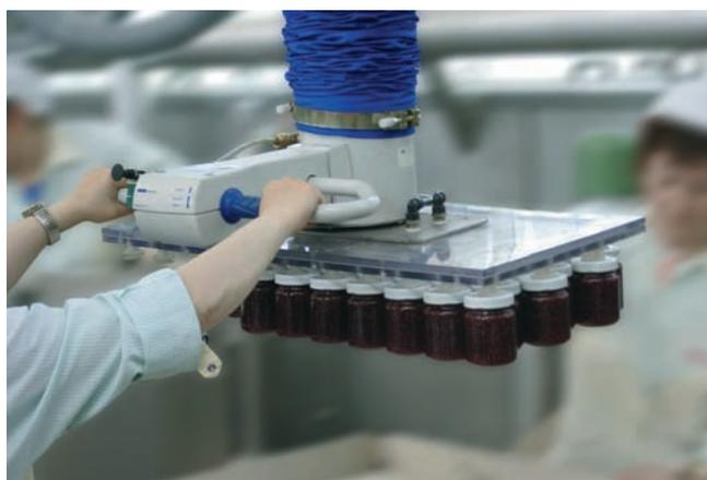
JumboErgo, максимальная грузоподъемность 85 кг., для одновременного переноса 48 банок с джемом
