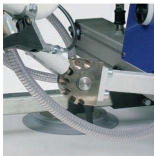
Поворотная фиксируемая рукоятка управления для простоты работы даже при подъеме на большую высоту
