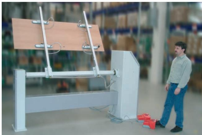
Вакуумный разворотный стол VWT 180° для переворачивания изделий
