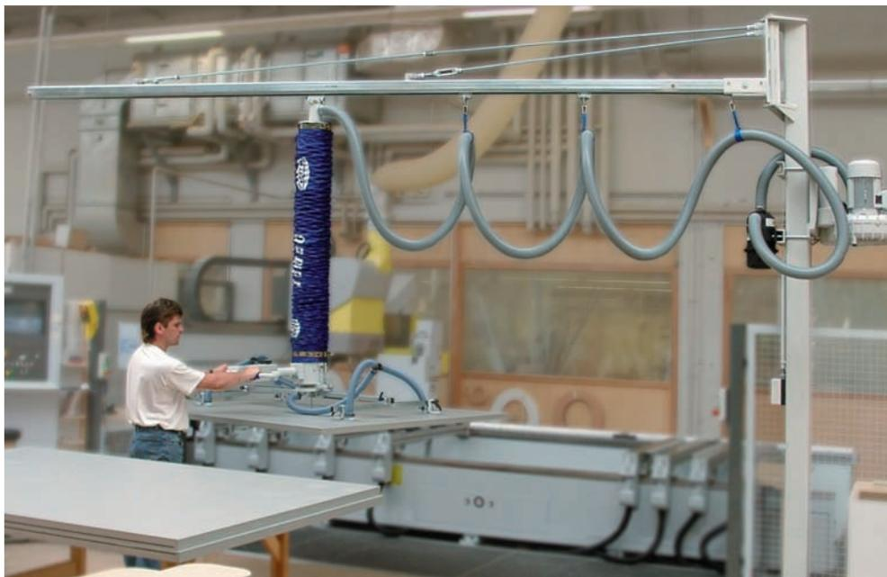
Jumbo Ergo, максимальная грузоподъемность 85 кг., с четверной присоской для загрузки и разгрузки деревообрабатывающего центра с ЧПУ
