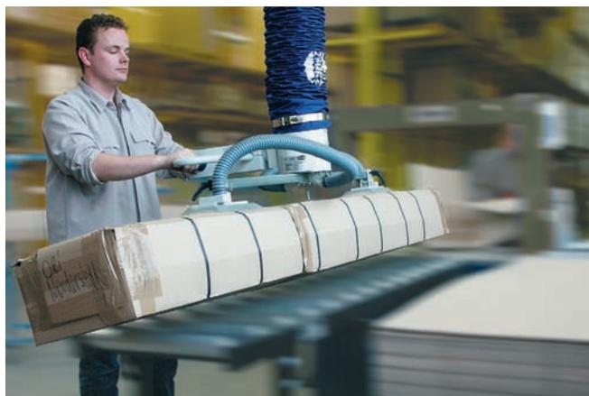
JumboErgo, максимальная грузоподъемность 85 кг., с двойным захватом для картонных коробок длиной до 4 м.
