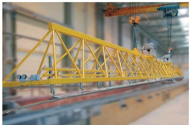
VacuMaster Roto, максимальная грузоподъемность 1500 кг., для манипулирования половинками лопастей ротора.
