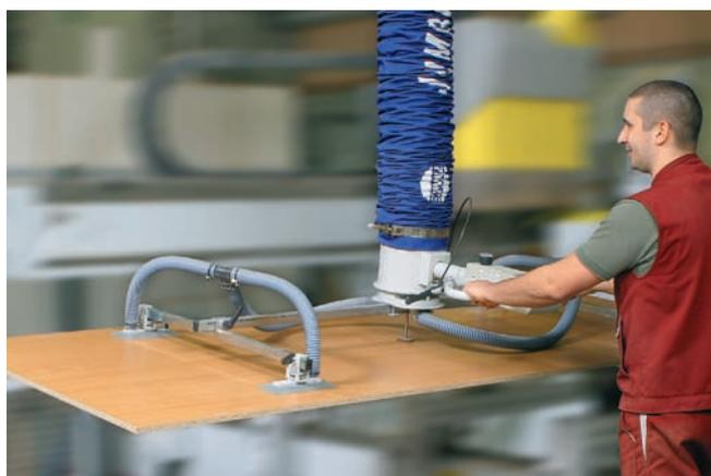
JumboErgo, максимальная грузоподъемность 85 кг., с четверным вакуумным захватом для загрузки и разгрузки деревообрабатывающего центра с ЧПУ
