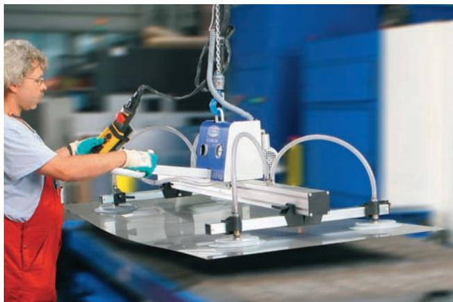
VacuMaster Basic, максимальная нагрузка 250 кг., для горизонтального перемещения грузов.
