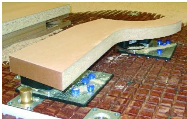
Блоки присосок Innospann, установленные на растровый стол
